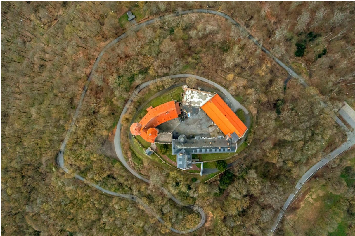
Veste Heldburg, Drohnensfoto (Björn Chilian, DBM, 2021). Zwei der Ravelins sind mit bloßem Auge zu erkennen, für die weiteren benötigt man die Lidar-Scans (in der Ausstellung)
